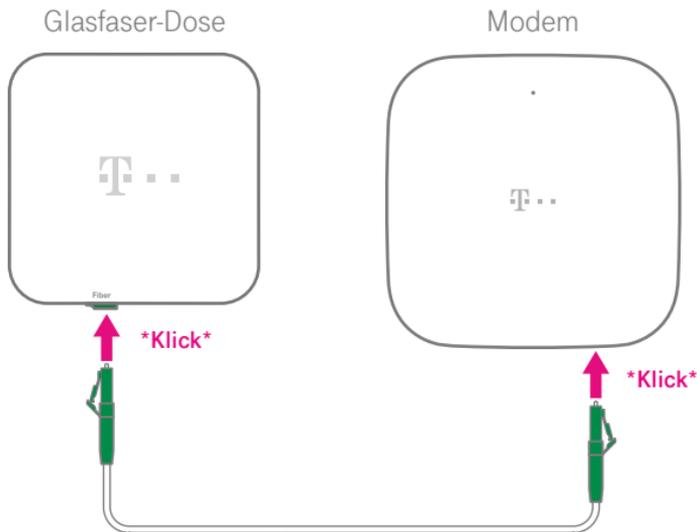
Schließen Sie das mitgelieferte Glasfaser-Kabel an die Glasfaser-Buchse Ihres Modems und die Glasfaser-Dose an. Achten Sie dabei auf die richtige Ausrichtung der Rastnase am Stecker. Die Stecker rasten hörbar ein.
